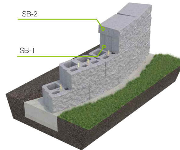
Рис. 2 - Схема радиусной подпорной стены
