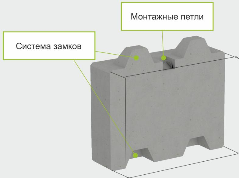
В верхней части блоков предусмотрены специальные выпуклости, а в нижней выемки. Блоки монтируются друг на друга, вставляясь один в другой очень точно и при монтаже не требуют применения связующего раствора, что позволяет быстро изменить форму смонтированной конструкции и экономить средства и время при монтаже. Из-за такой конструктивной особенности блока конструкции стен способны воспринимать не только вертикальные, но и значительные горизонтальные нагрузки.
