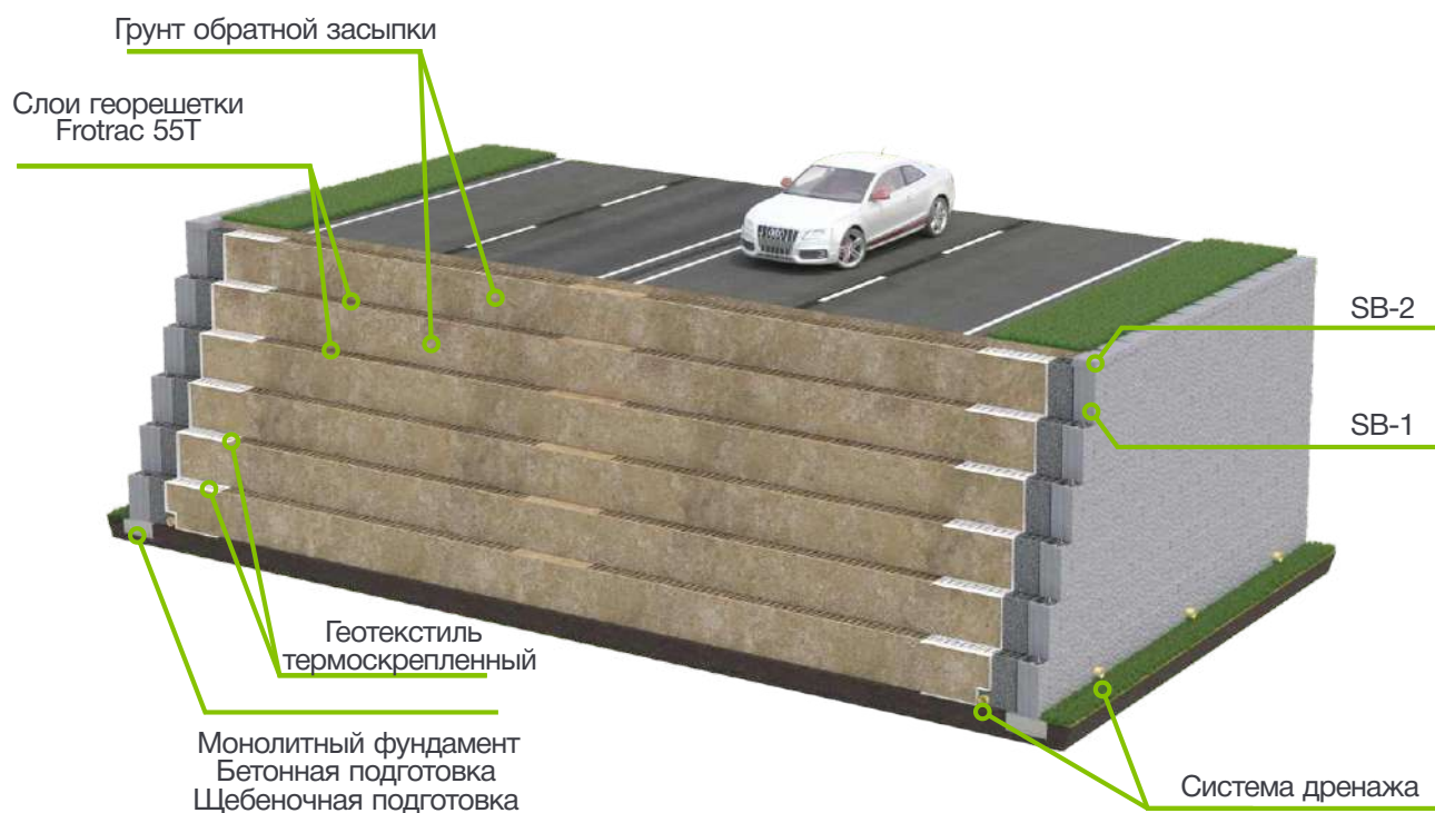
Рис. 1 - Схема насыпи с закреплением подпорными блоками
