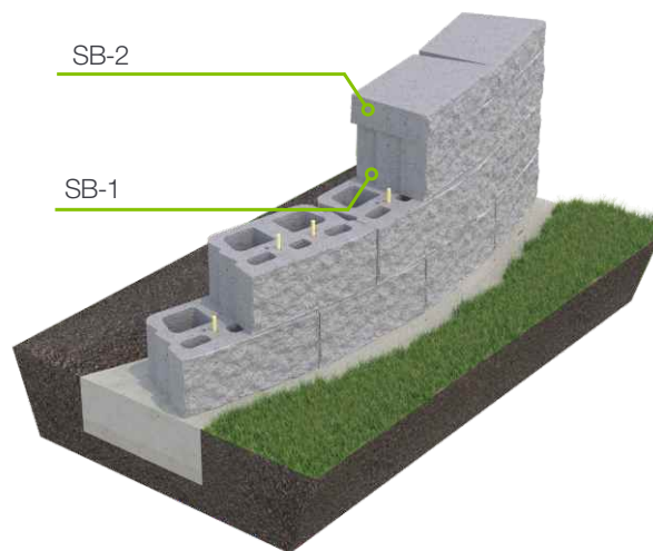
Рис. 2 - Схема радиусной подпорной стены
